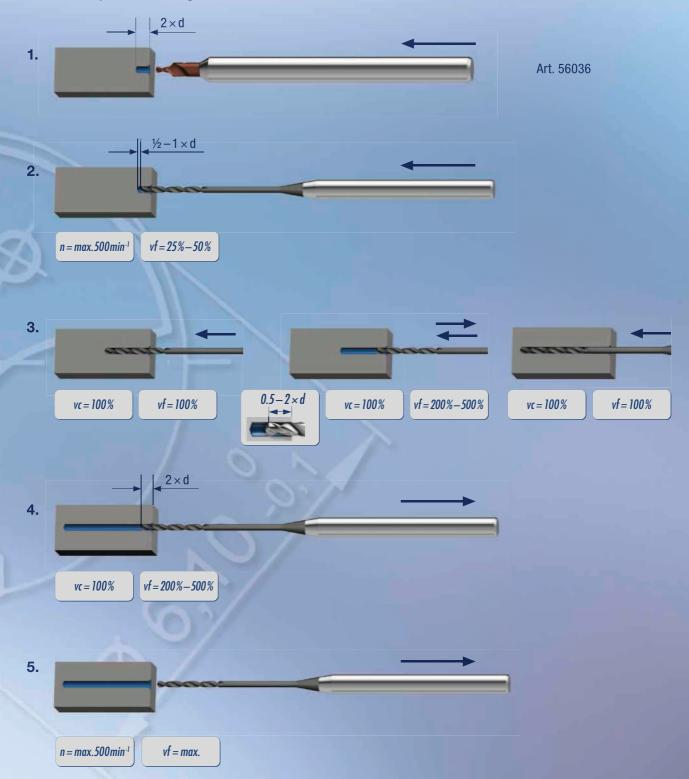
Bearbeitungsverfahren Hochleistungsbohren Procédé d'usinage à grand rendement Procedura d'usinaggio per foratura ad alto rendimento Machining process for high performance drilling
