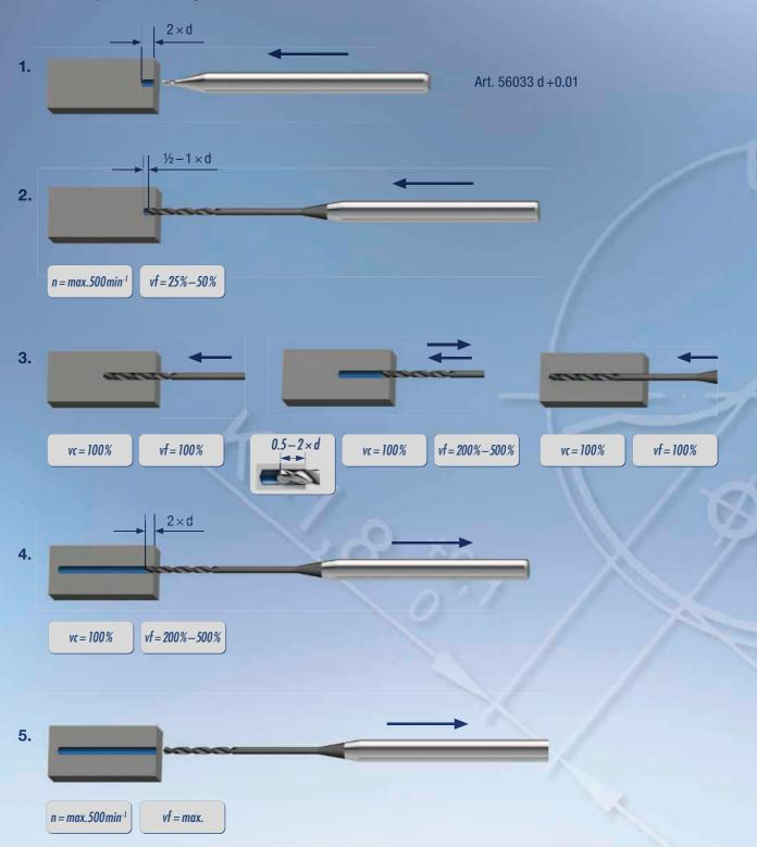
Bearbeitungsverfahren Mikrobohren Procédé d'usinage pour micro perçage Procedura d'usinaggio per micro foratura Machining process for micro drilling
